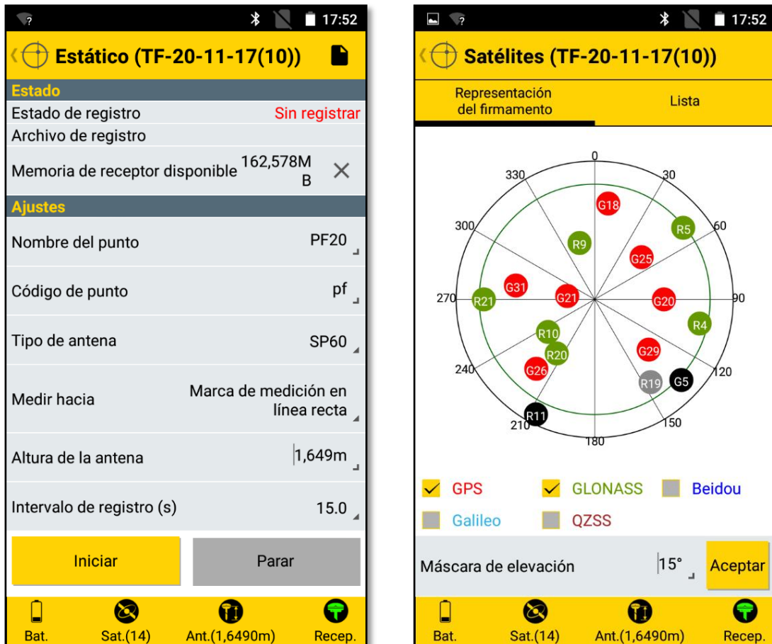
Figuras 33 y 34. Capturas de pantalla de la colectora que muestra las configuraciones de la observación y además los satélites visibles de cada constelación (GPS y GLONASS).
